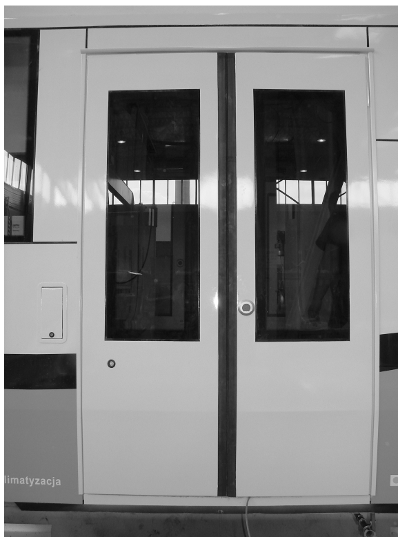
Rys.3. Drzwi wejściowe do pojazdu (odskokowo-przesuwne)
