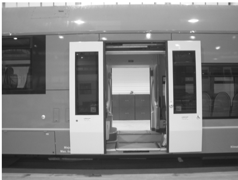
Rys.6. Drzwi wejściowe do pojazdu (odskokowo-przesuwne)
