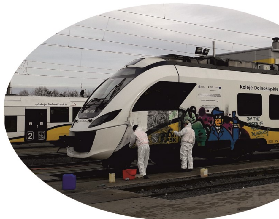
Zdj. 14 – usuwanie dewastacji, fot. KD
