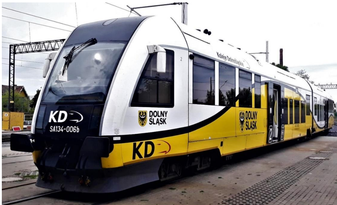
Zdjęcie 9. Spalinowy zespół trakcyjny – SA134
