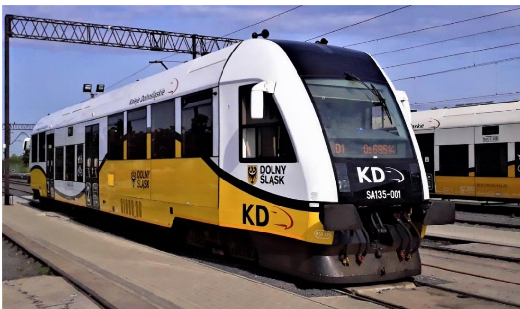
Zdjęcie 10. Spalinowy zespół trakcyjny – SA135
