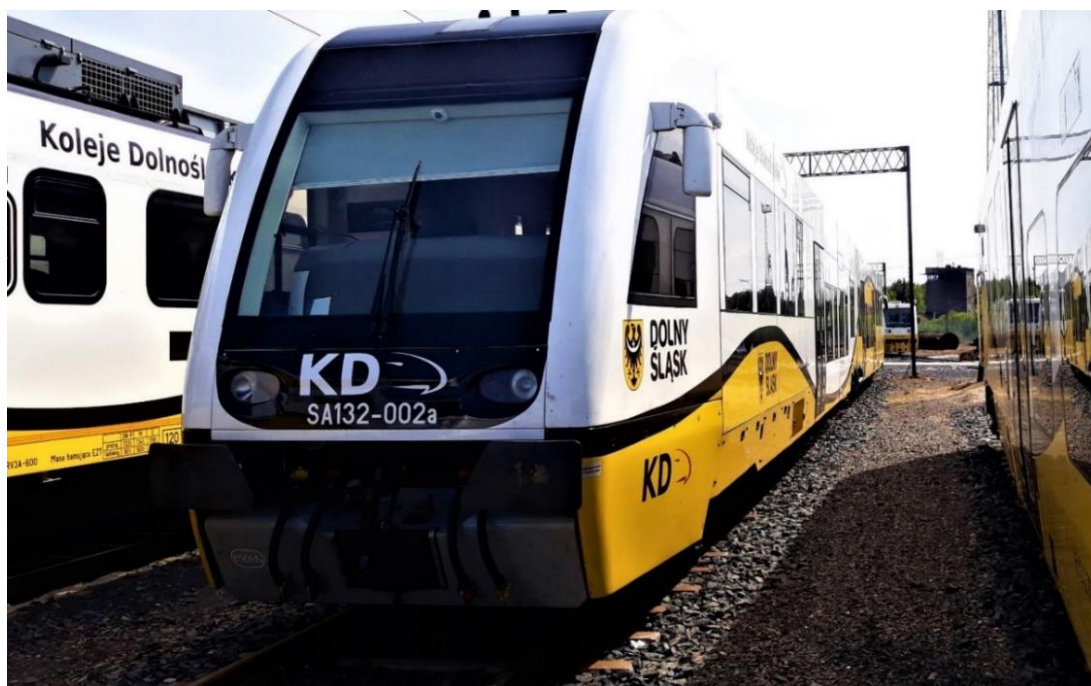
Zdjęcie 8. Spalinowy zespół trakcyjny – SA132
